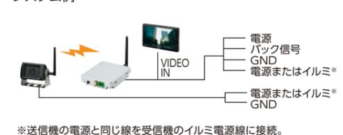
※送信機の電源と同じ線を受信機のイルミ電源線に接続。
